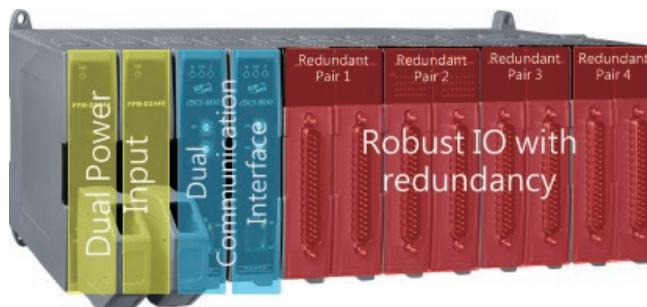
在 IO 這一塊，泓格提出了 iDCS-8830 遠端 IO 系統，iDCS-8830 支援工業控制最常用的 Modbus/TCP 通訊協定，可透過結合不同種類的 IO 進行符合需求的配置。iDCS-8830 的主要特色是能夠將 IO 模組做雙重化配置，在雙重化配置下的 IO 模組，若主要模組損毀，
