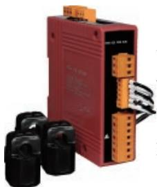
泓格科技新推出的三相智能電錶 PM-3133，讓您可取得即時的三相電力系統量測資訊。因其具備高精度 (<0.5% , PF=1) 之特性，PM-3133 可適用於低電壓的一次側以及中 / 高電壓的二次側，使用戶能夠獲得可靠和準確的能源消耗數據，並進行即時的設備監控與操作。除了精巧的尺寸和高性價比之外，PM-3133 也提供開口式 CT 的量測方式 ( 支持不同的類型，輸入電流最大可達 200 A )，其輸入電壓範圍為 10 ~ 500 VAC，可相容於各國電壓規範；PM-3133 亦支援 2 路繼電器輸出，可與警報器或燈控作整合，於電力出現異常時發出警報訊息。
