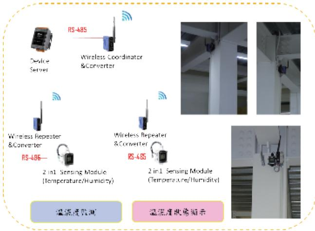
佔地廣大，拉線複雜，故採用無線傳輸模組來監測各區溫濕度狀況，並記錄數據，及事件告警。
