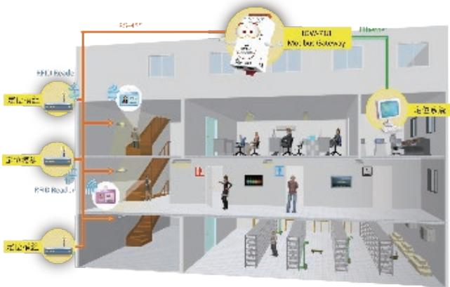
在某辦公室大樓，可將管理監控中心的定位系統經由 Ethernet 連接至 tGW-718 的 Ethernet Port，再將 tGW-718 的 RS-485 串列端連接至各區域的定位模組及照明燈（如：樓梯燈、走廊燈…等），當工作人員戴著具有 Tag 的識別證，經過定位模組附近時，將會無線偵測到識別證上的 Tag，並且被記錄下來，此時管理監控中心的定位系統便經由遠端透過 tGW-718 去讀取定位模組，當定位模組上的數據資料顯示有人員時，管理監控中心將自動傳送指令來開啟人員所在位置的照明燈，當定位模組上的數據資料顯示無人員時，管理監控中心將再次傳送指令來關閉照明燈，因此管理人員除了能了解工作人員動向外，燈控的有效控制更是切實達到便利、節能及減碳，且保護地球環境的責任也得以落實。
