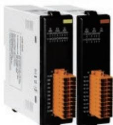
USB-2000 透過 USB 的隨插即用功能以及 USB 纜線供電之便利性, 使用者可透過 USB-2000 進行快速且簡便設備控制。數位輸入部分, 除了提供基本的數位輸入量測外, 並加入了數位濾波及計數器等功能。而在數位及繼電器輸出部分, 除輸出數位訊號外, 開機初始值也內建在這些模組內, 此外安全輸出值為另一項特色用來保護現場設備。繼電器輸出規格為最大 240VAC 或 30VDC 工作電壓, 且接點可承受最大 5A 之電流, 此規格可滿足使用者多數的裝置控制應用, 如: 電燈、電扇、警報系統以及其他工業自動化之電子裝置。
