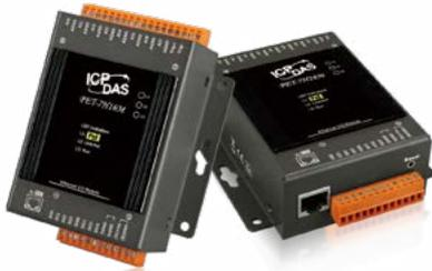
PET-7H16M/PET-7H24M 是具有乙太網路 (PoE) 的高速同步數據採集模組。PET-7H16M 提供 8 個高速 16 位元單端類比輸入通道 (最高速 200 kHz / 每通道) · PET-7H24M 則提供 4 個高速 24 位元差動式類比輸入通道 (最高速 128 kHz / 每通道)。兩款高速數據採集模組的通訊通道皆可同時進行 A/D 訊號轉換，且所有通道可自行調整輸入範圍設定。除此之外，亦提供 DI / DO / 計數器 / 編碼器轉換功能供使用者搭配選用。PET-7H16M/PET-7H24M 具備 4 kV 靜電防護與 2500 VDC 的內部隔離，有極高的可靠度及穩定性。
