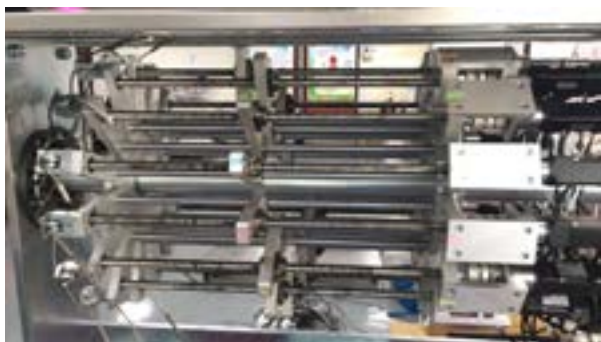
▲ 圖三、控制機箱內的多軸線性致動器
