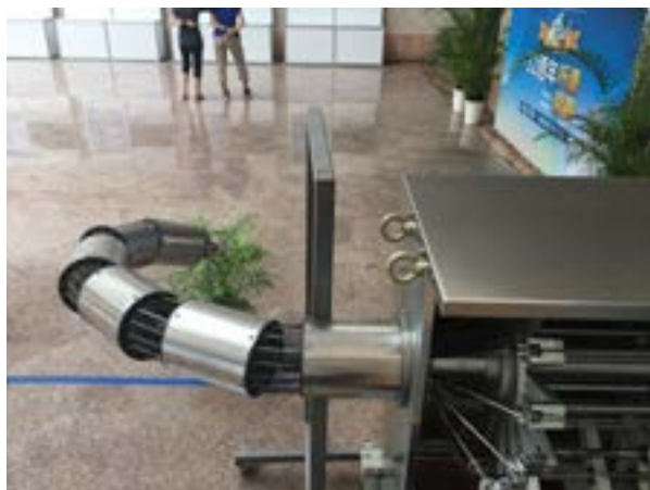
▲ 圖二、蛇臂機器人的幾個姿態
