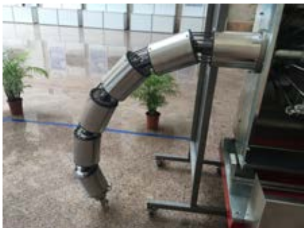
▲ 圖二、蛇臂機器人的幾個姿態
