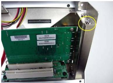
步驟 6: 將您的 PCI 卡插入 PCI 插槽直到完全到位。
