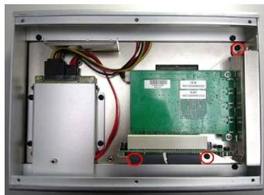
步驟 5: 讓 PCI Bus 三角底架豎直並且鬆開擋板螺絲。
