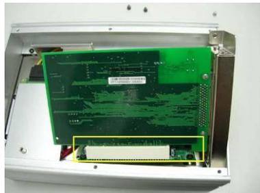
步驟 7: 確認 PCI 卡安裝正確然後將擋板螺絲鎖上.
