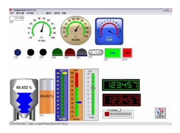
EZ Data Logger: 泓格科技提供的,免费小型数据采集系统。可以自动扫描系统中已经连接的扩展L/O,提供丰富的控件供客户制作人机界面,并可以通过简单的命令脚本设定逻辑。有了EZ Data Logger的帮助,用户不需具备程序开发技巧,就可以很快且容易地架构一个数据采集系统。
