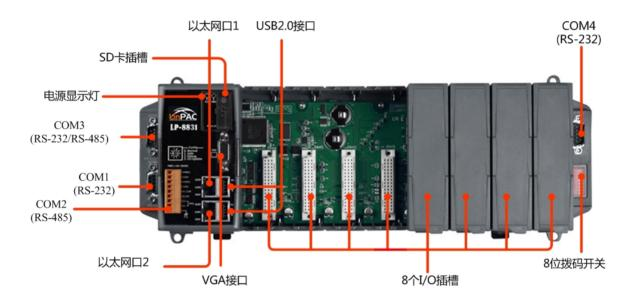
LinPAC在硬件上采用和XPAC、WinPAC几乎完全相同的设计,同样提供双电池备援的SRAM (512 KB),双以太网络端口,双电源输入,双看门狗,丰富的冗余方案等的支持。
