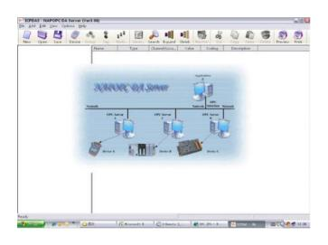
OPC全称是OLE for Process Control,它的出现为基于Windows的应用程序和现场过程控制应用建立了桥梁。泓格公司推出的OPC Server提供标准的信息交换接口,方便其他设备进行连接。
