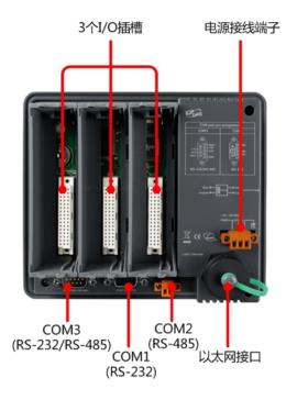
ViewPAC系列产品提供Web/FTP/Telnet/SSH Server内建服务,采用多种连接方式(USB、以太 网、RS-232/485),具有3个I/O扩展槽,STN、 3.5"/5.7"TFT液晶显示屏和1个橡胶键盘。 ViewPAC作为PAC家族的新成员,保持了PAC产品一惯的稳定性、实时性、体积小的优势,与传统的HMI+PLC解决方案相比较,ViewPAC减少了总体系统产本、空间。给您带来密集型可视化控制系统的全新体验。
