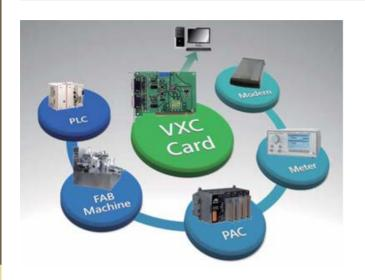
泓格科技为用户提供了VXC系列,基于 Universual PCI总线的多串口卡,可以为用户扩展出 多个标准的RS-232, RS-422/RS-485串口,除具备有 PCI总线标准的即插即用功能(Plug & Play)之外,还 可以使用COM-Selector锁定多串口卡所提供的串口 在操作系统中对应的串口号和地址。用户可以选择 让系统自动分配或者完全由自己控制,提供了更大 的灵活性。
