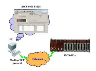
iDCS-8830 Utility 是一个专门为iDCS\_8000系列产品开发的一个配套软件产品,可以用来对iDCS-8000系列产品的相关参数进行设置,也可以帮助工程人员调试和监测硬件状态,以便于更好的解决现场问题。
