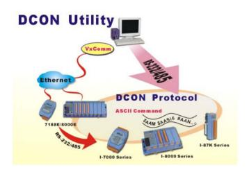
DCON协议是用于I-7000/8K/87K 系列的一种问/答 式通讯协议,它的定义是一种简单的ASCII码格式,如 \$AAN,\$AAS6,#AAN...等等,可以采用RS-232、 RS-485或以太网等通讯方式。
