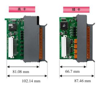
泓格科技的I-8K, I-87K模块还区分为高卡版本和矮卡版本,适合配套不同类型的PAC和I/O扩展单元。我们推荐用户优先选用高卡版本的I-8K, I-87K模块,一般来说,高卡版本的模块拥有更好的性能和I/O保护,I-87K高卡模块采用支持热插拔设计,配套某些种类的PAC和I/O扩展单元,可以实现I/O模块热插拔,在提高用户自动化系统鲁棒性的同时,也能大幅降低系统的维护成本。
