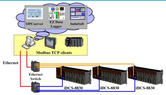
直接连接SCADA系统
