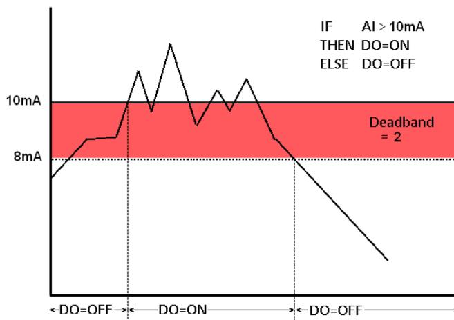
图 5-4: AI Deadband 示意图(作用于大于条件)
