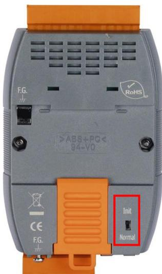
图 2-1: 控制器上的 Switch 位置图
