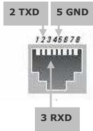
**WIRING MAP FOR SERIAL CABLE**
