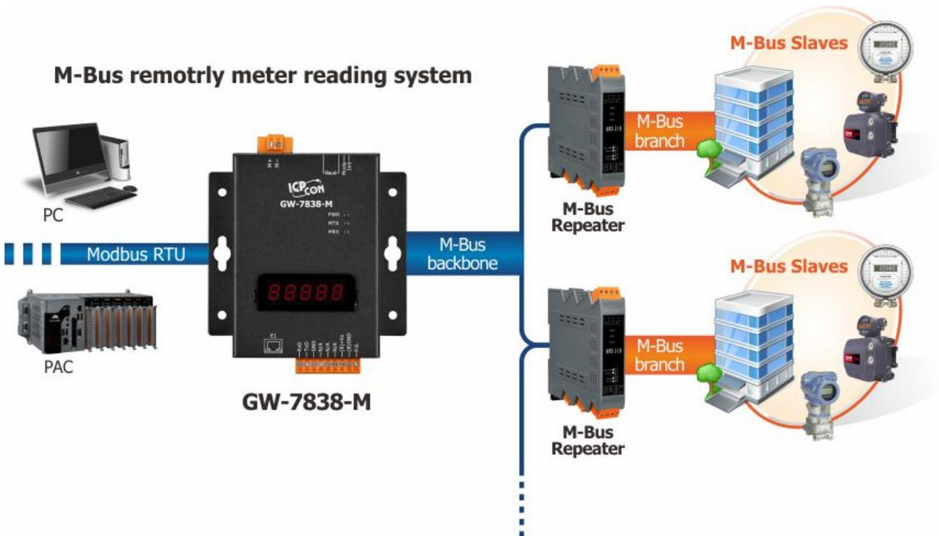
M-Bus (儀錶總線) 是歐洲針對遠端讀錶所發展出一種通訊標準，M-Bus 適用於大多數的消費型儀錶以及各種不同的傳感器與驅動器，而 GW-7838-M 則是特別針對 Modbus TCP 主站以及 M-Bus 從站設備所設計的閘道器，它除了提供 Modbus TCP，也提供 RS-232 的 Modbus RTU 兩種通訊方式，讓 Modbus 主站可以直接讀取到 M-Bus 上的設備資料。在硬體的設計上有一組六位的指撥開關，可設定 RS-232 與 M-Bus 通訊的通訊速率，並提供使用者自訂鮑率的設定，通訊部分則採用 Modbus TCP/RTU 功能碼 0x03 與 0x04，使用者可以透過 GW-7838-M 讀取到所需的 M-Bus 從站資料。
