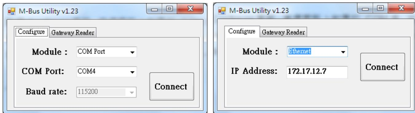
點選 **Configure** 頁籤，選擇電腦上對應的 **COM** 埠，或是選用 **Ethernet** 並輸入 **GW-7838-M** 的 **IP Address** 後按下 **Connect** 按鈕即可與 **GW-7838-M** 模組連線，其中 **UART** 的通訊速率在 **GW-7838-M** 設定模式下固定是 **115200bps**。
