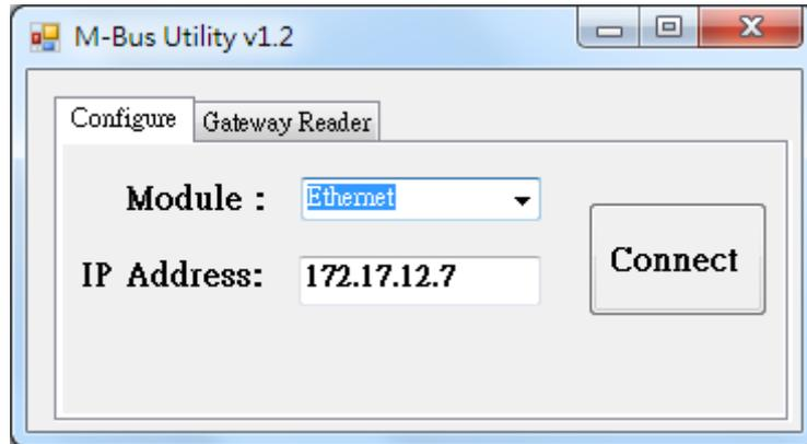
在完成儀錶的設定之後，可以開啟 M-Bus Utility 點選 Gateway Reader 來測試讀錶資料是否設定正確。
