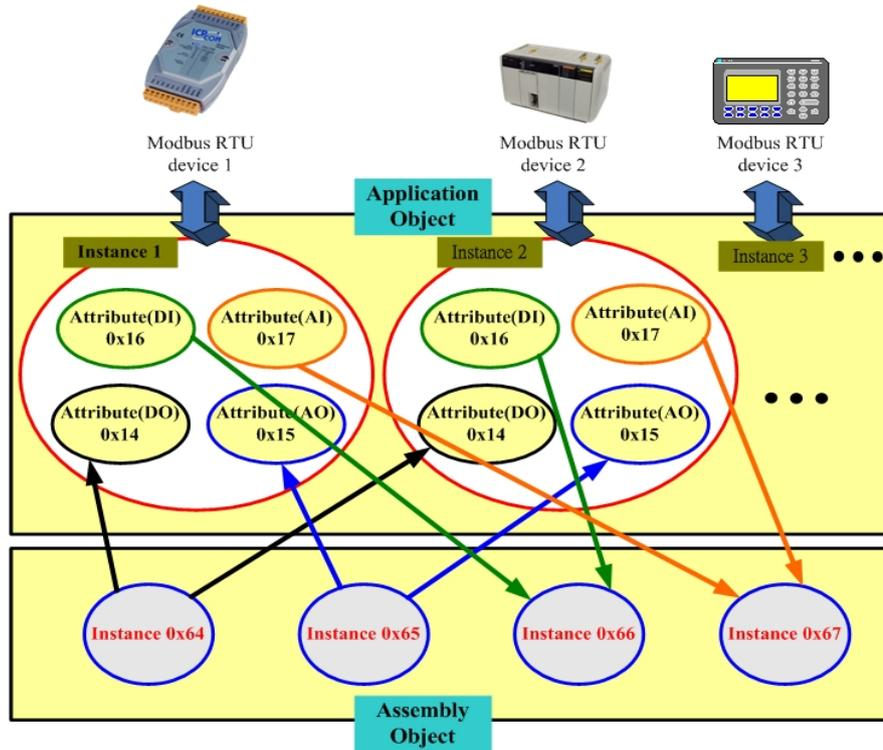
**Example :** (one DO device 、 one DI device 、 one AO device 、 one AI device)
