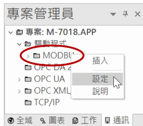
在 MODBU 視窗中，選擇適當的通訊 COM 埠 (可手動輸入，例如: COM5) 與參數 (鮑率: 9600、資料位元: 8、停止位元: 1、同位位元: 無)。請確認 Protocol 欄位是選取 RTU，再按 確定 按鈕。
