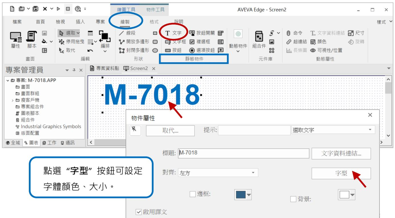
畫面中再添加 2 個文字物件，標題為**熱電偶溫度狀態** 和 **Channel 1 : #####**，「#」數量代表資料要顯示的長度 (包含小數點)。滑鼠雙擊 **Channel 1 : #####** 開啟物件屬性視窗，並點選 **文字資料連結** 按鈕，在 **資料點/運算式** 輸入 **AI**。
