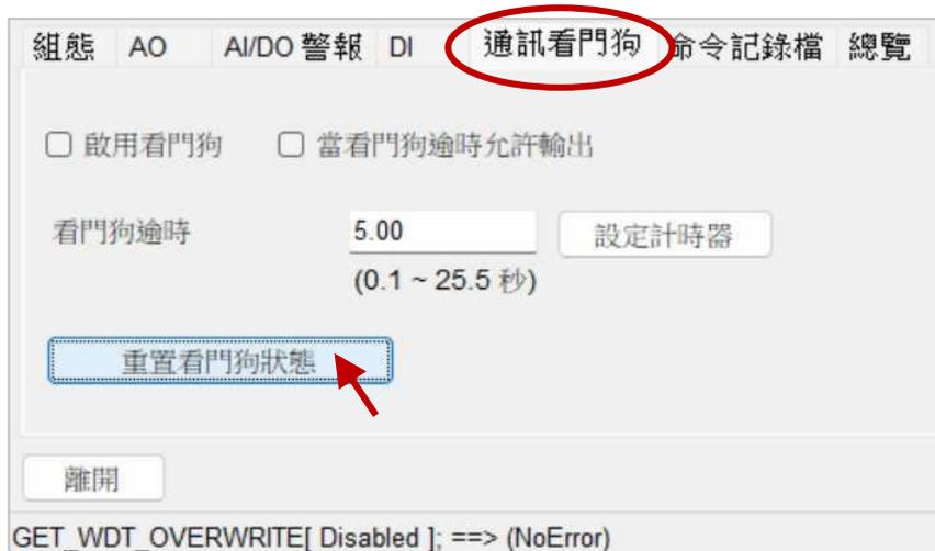
**註：** 用戶也可透過將 Modbus 位址 40492 寫入 0 或透過 DCON 的 ~AA1 指令，來清除 Timeout 狀態。
