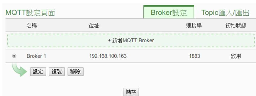
圖9-7: MQTT Broker 設定頁面
