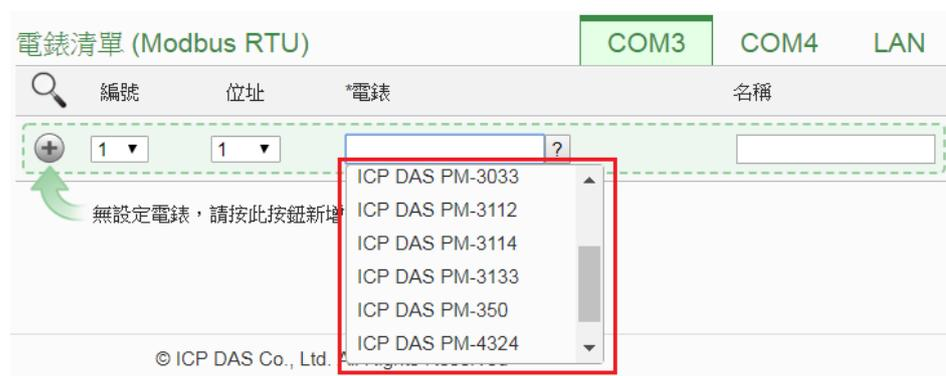
圖7-9: Modbus RTU 電錶類型設定
