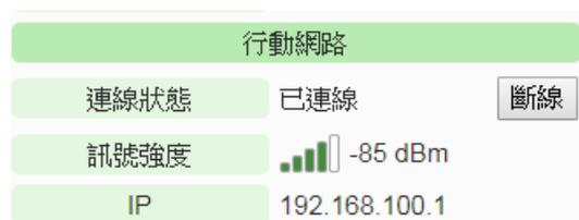
圖6-5: 行動網路 IP 位址與訊號強度顯示介面
