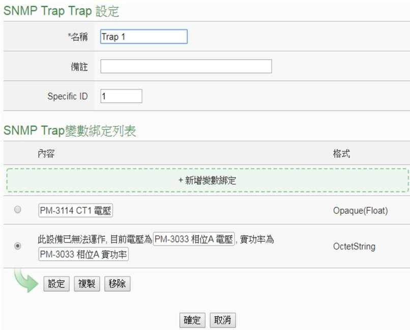
圖10-19: SNMP Trap 參數設定頁面(包含“變數綁定”列表)
