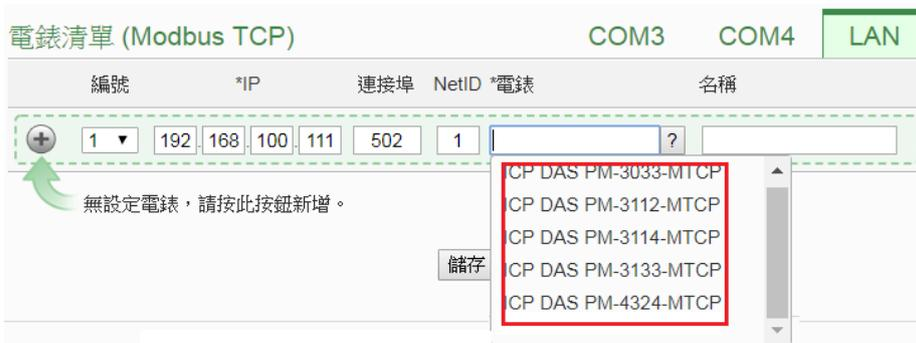
圖7-12: Modbus TCP 電錶類型設定
