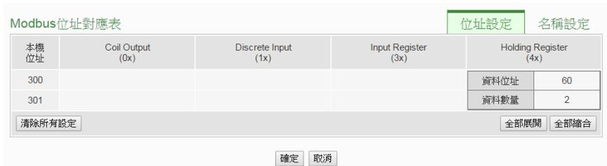
圖 7-50: Modbus RTU 模組 Holding Register 資料設定頁面範例
