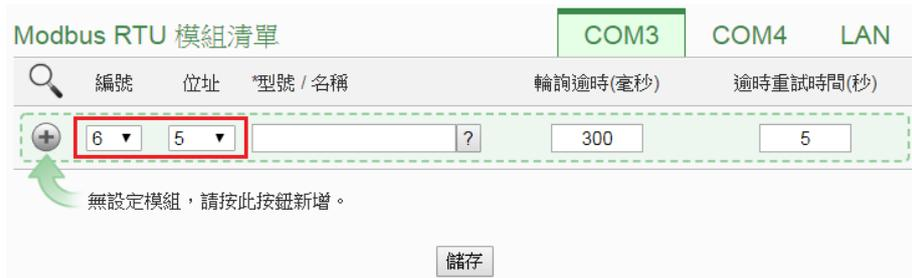
圖7-32: Modbus RTU 模組編號與位址設定
