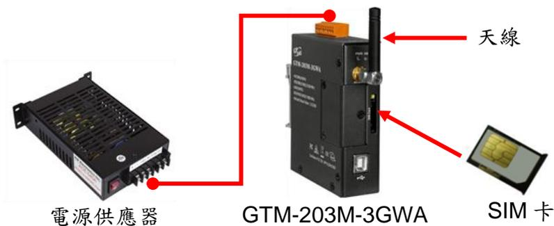
步驟二、透過 USB 線將 GTM-203M-3GWA 連接至 PMD 的 **USB**。
