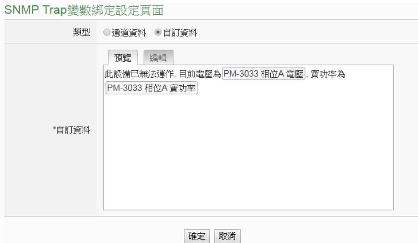
圖10-18: “預覽”模式下的“自訂資料”類型設定頁面
