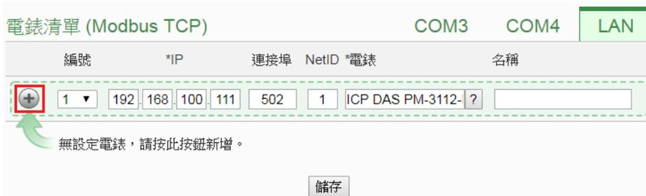
圖7-13: 完成手動新增 Modbus TCP 電錶
