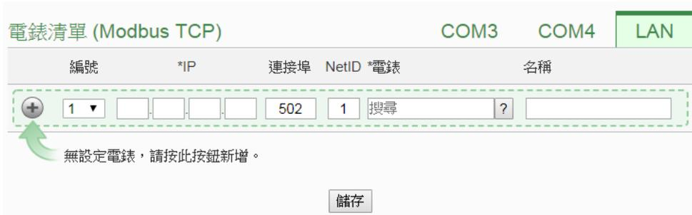
圖7-11: 新增 Modbus TCP 電錶頁面
