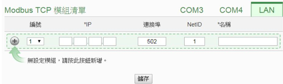
圖 7-35: 新增 Modbus TCP 模組頁面
