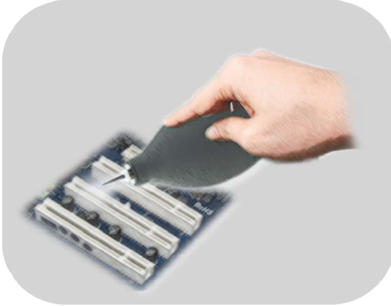
步驟 7: 清潔完插槽後，再將 PCI/ISA/PEX 卡小心插入 PCI/ISA/PCI Express 插槽，然後啟動電源開機。
