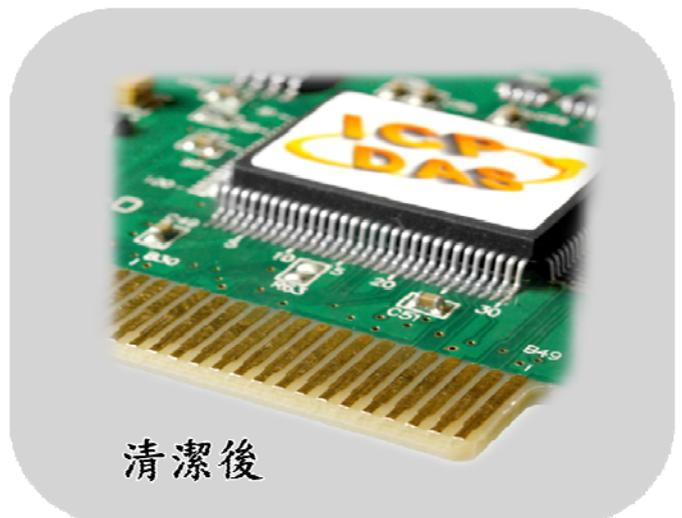
步驟 6: 再使用清潔器-吹氣球來清除殘留在主機板及 PCI/ISA/PCI Express 插槽上的灰塵。
