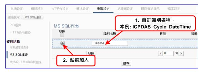
加入資料庫後 (如下圖,例:識別名稱 ICPDAS\_Cycle\_DateTime) ·請再點選 MS SQL 列表的 [編輯] 按鈕 · 進入遠端資料庫內容設定的頁面。
