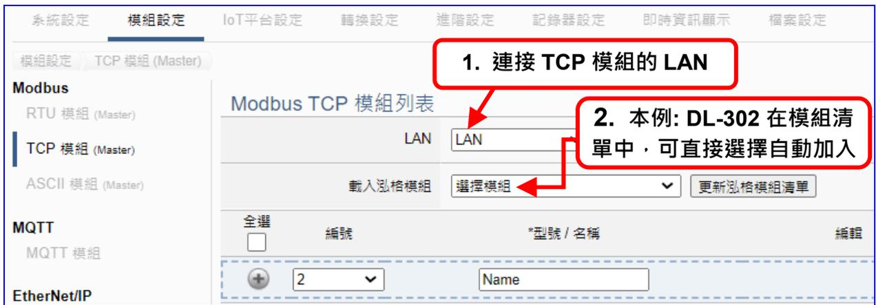
加入模組後 (如下圖, 例: 編號 1 的 **DL-302**)，請再點選模組的 [編輯] 按鈕，進入模組內容設定的頁面。
