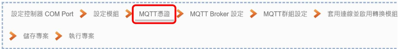
**[MQTT 憑證]** 步驟主要是為了 **MQTT 通訊的安全加密**，上傳設備的 MQTT 憑證，需要先取得連接設備方的 MQTT 憑證檔案，有三種類型：信任憑證、憑證、私鑰，依據取得的憑證類別，上傳到 UA 控制器中。**若需要進行 Broker 驗證，用戶需上傳信任憑證，若要進行 Broker/Client 雙向驗證，則需再上傳憑證和私鑰。若專案不需要安全性連線，可跳過此步驟**(後續若需要，仍可在 **[檔案設定 > MQTT 憑證]** 功能表上傳)。
