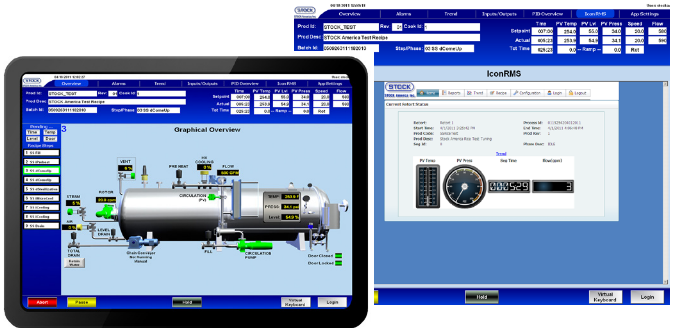
▲ (蒸餾機、相關氣壓及循環泵狀態監控)
