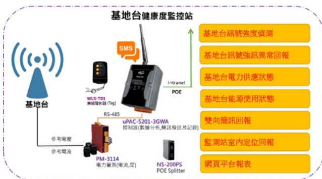
▲ 圖一 基地台健康度監控站功能架構
