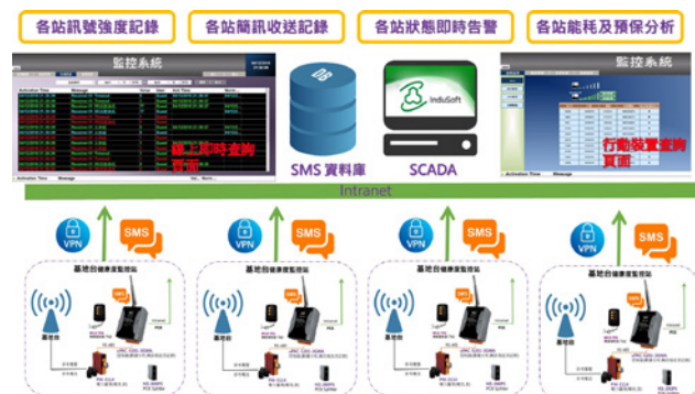
▲ 圖二 基地台健康度監控系統功能架構
