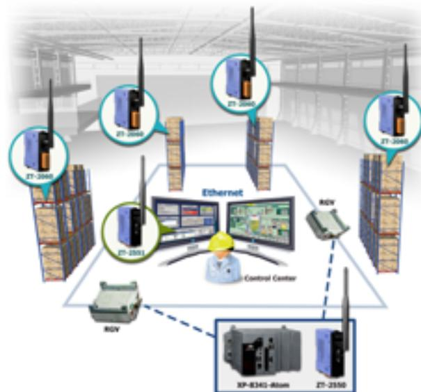
客戶的應用在一個複合式的倉儲作業區，現場人員可以呼叫無人搬運車過來取物，並且控制無人搬運車運送物品到指定地點，靈活的應用方式可以節省無人搬運車停滯的時間，讓無人搬運車的使用更有效率。
