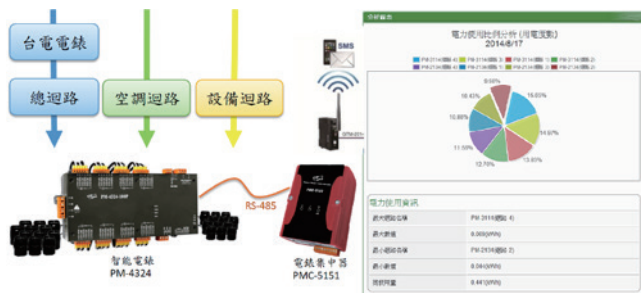
▲ 圖 3 泓格科技智能電錶系統架構以及用電分析
