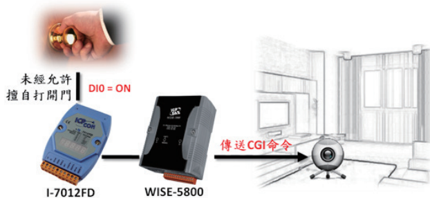
▲ 圖九 泓格科技智能控制器 -WISE-5231 IP CAM CQI/MQTT 應用架構
