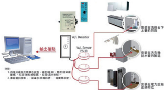
▲ 圖(五) 現行客戶漏液監控系統架構
