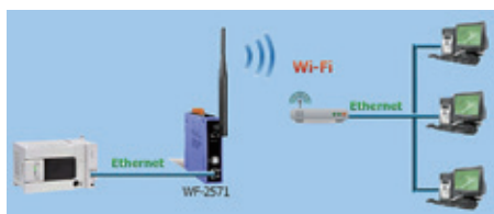
▲ WF-2571 之 Infrastructure 架構
