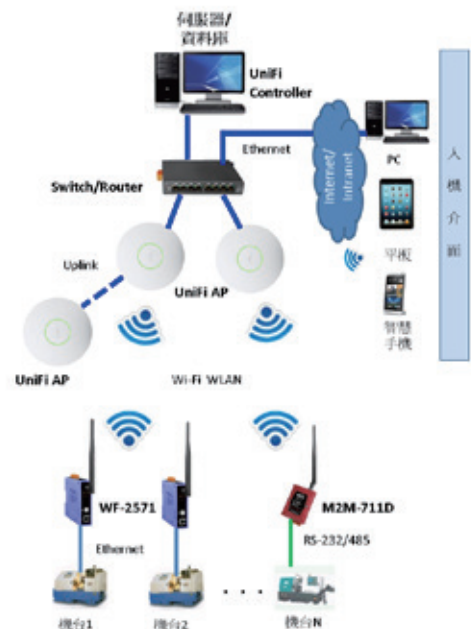
▲ 應用 Wi-Fi 之機台遠端監控應用架構
