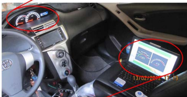
利用 I-7565-H2 監視車內 CAN 訊息，顯示引擎資訊
