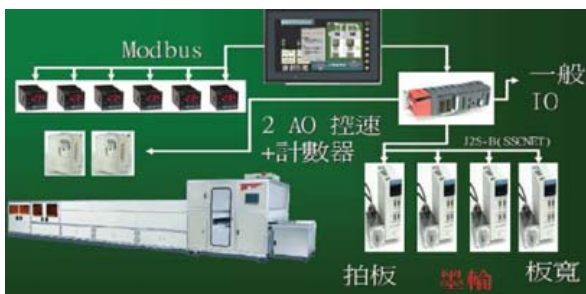
图1：传统PLC架构
