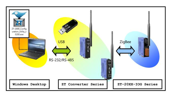
(2) 首先,必須使 ZT-20xx-IOG 模組與 ZigBee 轉換器之間建立無線通訊;換言之,透過 ZT-2000 Configuration Utility 將 ZigBee 轉換器設定至下列參數,以利與 INIT 模式下的 ZT-20xx-IOG 模組建立無線通訊:
