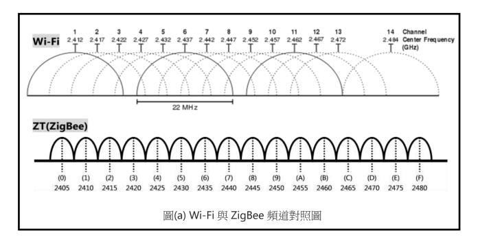
再對照下列【圖(b)Wi-Fi 與 ZigBee 頻道對照表】,得知 2423 ~ 2426(MHz)、 2448 ~ 2451(MHz)、2473 ~ 2480(MHz)這三個頻段恰為 ZigBee 頻道 4、9、E、 F,則這四個 ZigBee 頻道可以優先選用,避免與 WLAN 頻寬重疊。
