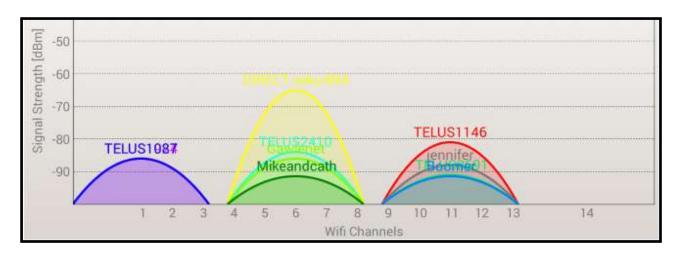
再透過下圖【圖(a)Wi-Fi 與 ZigBee 頻道對照圖】,得知正在使用的 WiFi 頻道 1、6、11 的頻段分別是 2412±11(MHz)、2437±11(MHz)、2462±11(MHz),這三個頻率範圍對於同頻段的 ZigBee 網路而言,是一個無線干擾源;換句話說,此時沒有被佔用的閒置頻道:2423 ~ 2426(MHz)、2448 ~ 2451(MHz)、2473 ~ 2480(MHz)是最佳的選擇。
