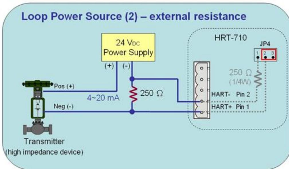
圖 2.3.4-2：“點對點”模式(2 線式儀錶，外部電阻)
