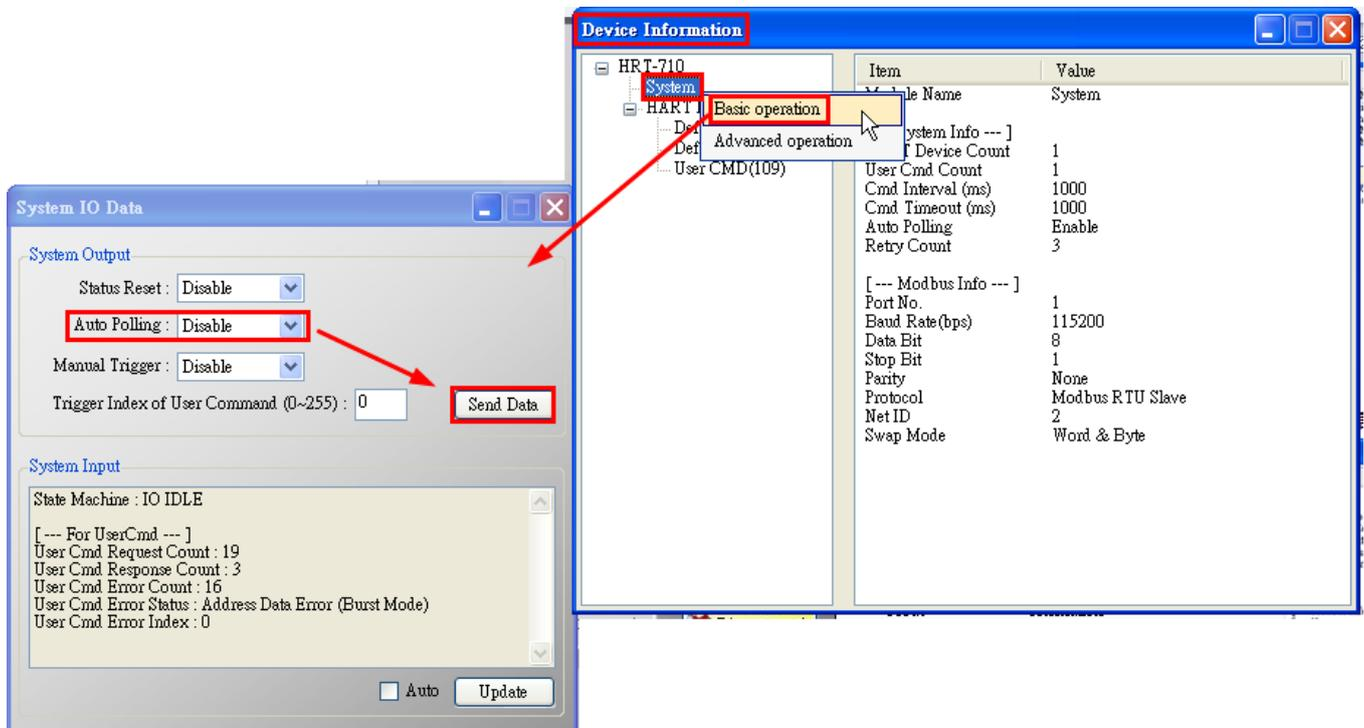
(2) 開啓 Through Mode 畫面，先送出 CMD0 來取得 HART 設備 Long Frame Address。
