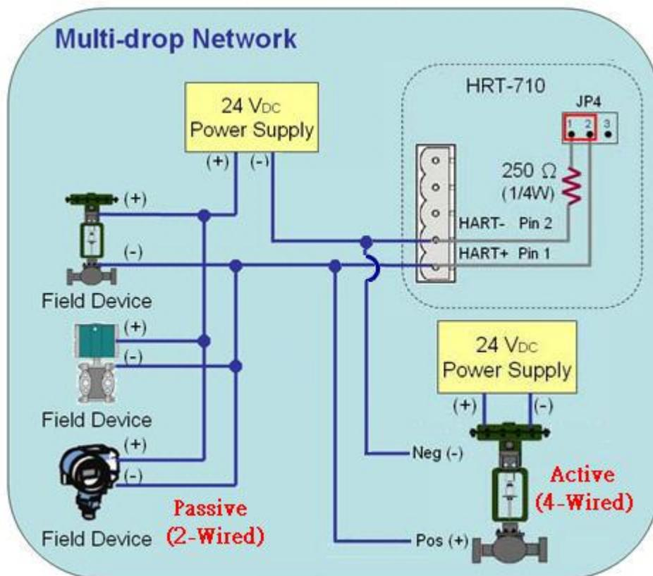
圖 8-1：Active 及 Passive 之 HART 儀錶之 HART 網路接線方式
