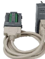
I-87018ZW 使用 CD-2518D 线缆连接 DB-1820
